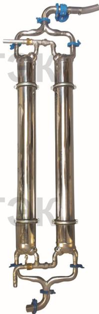
Трубчатый предоохладитель Mueller охлаждает молоко перед поступлением в емкость для хранения. Молоко отдает свое тепло воде, которая течет в противоположном направлении. Трубчатый предоохладитель существенно снижает расход энергии на выработку холода холодильным агрегатом, и на протяжении всего процесса охлаждения молока сэкономленная энергия достигает значительных объемов.
